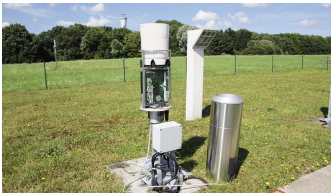
Abb. 2: Niederschlagsmessstelle Fuhlsbüttel mit elektronischem Sensor – gemessen werden Dauer und Intensität in hoher zeitlicher Auflösung (Quelle: Deutscher Wetterdienst)
