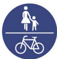
Abbildung 7: Gemeinsamer Geh- und Radweg, VZ 240
