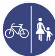
Abbildung 9: getrennter Geh- und Radweg, VZ 241-30
